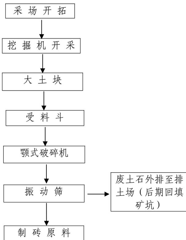
图 3.3-1 矿山开采工艺流程图
